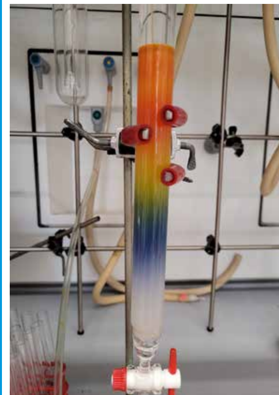
Purificación de productos de una síntesis por cromatografía en columna
