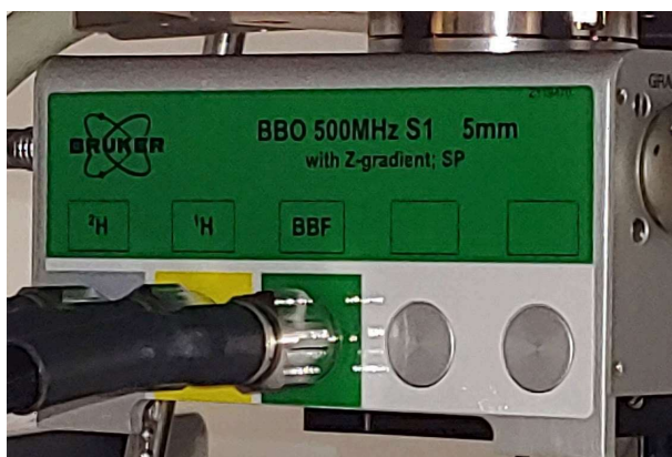
Figura 1. Sonda SmartProbe BBFO
