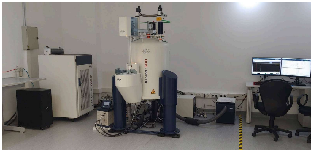
Figura 3. Resonador magnético nuclear Bruker Avance NEO 500 MHz en CIBION
